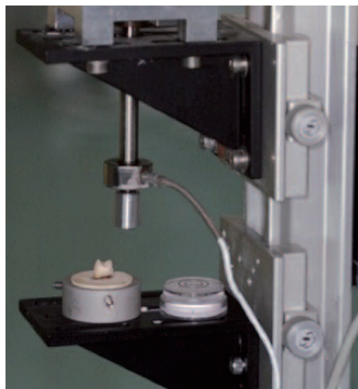
Fig. 7 Machine de traction avec la cellule M235-5DG (Physics Instrument).
